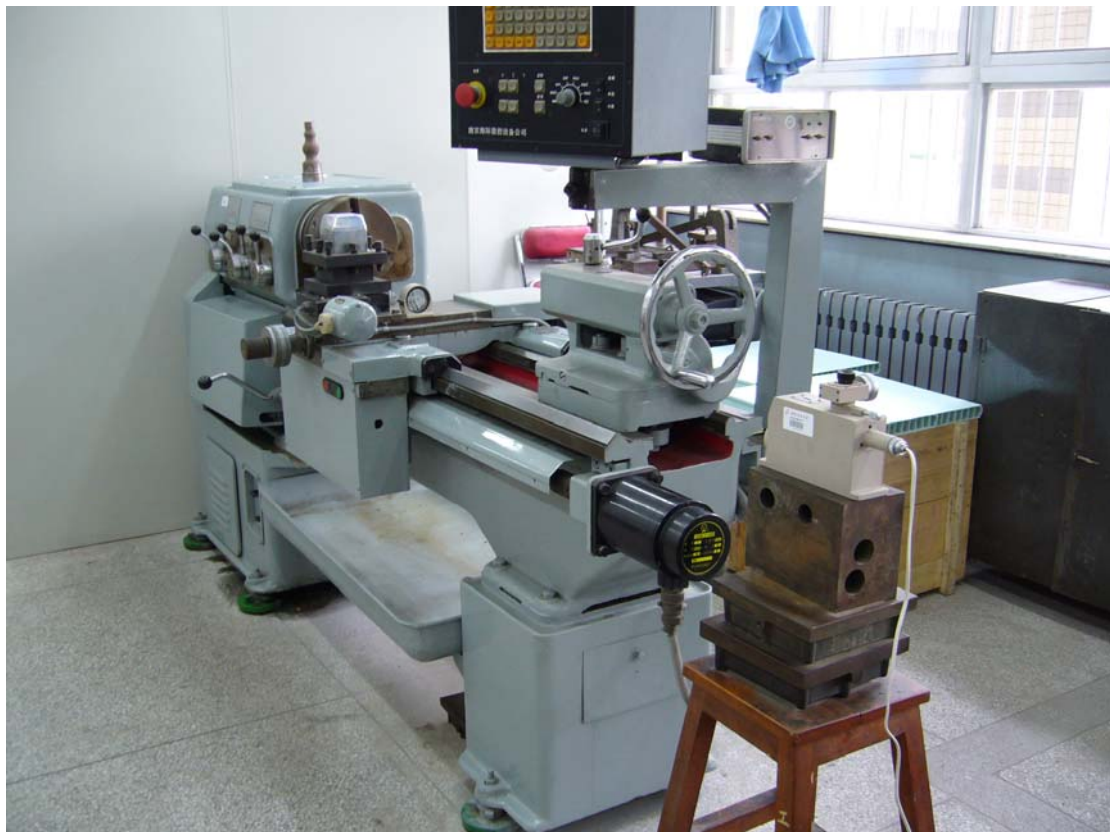
车床几何精度检验设备仪器
